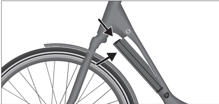
Abb. Tube Rahmenakku einsetzen
